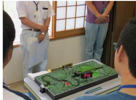
(模型を使って直線化した河川と蛇行河川における流速、水位の変化を観察)
